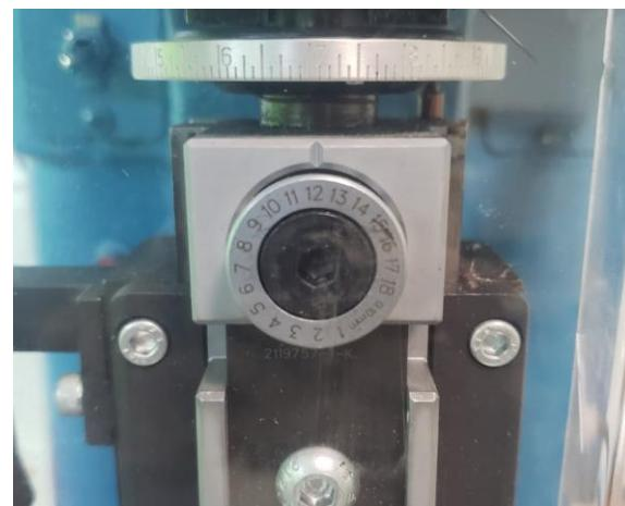
5. Asegurarse de que la terminal a colocar este bien centrada en la fixture donde colocaremos el cable a crimpar.
